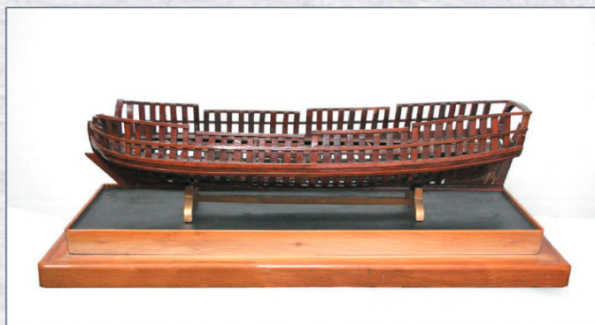
Неизвестный мастер Модель конструкционного набора английского линейного корабля XVII века Англия, вторая половина XVII века
