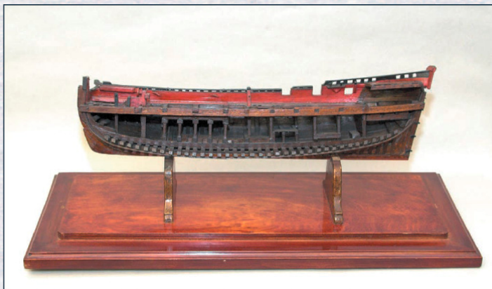
О. Най Модель 6-пушечного бомбардирского корабля «Дондер» в разрезе 1772
