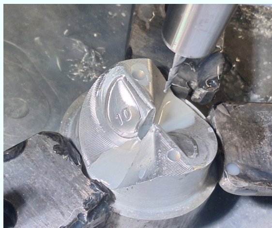
Процесс изготовления формы для отливки винта
