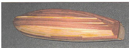
Обшивание корпуса рейками
