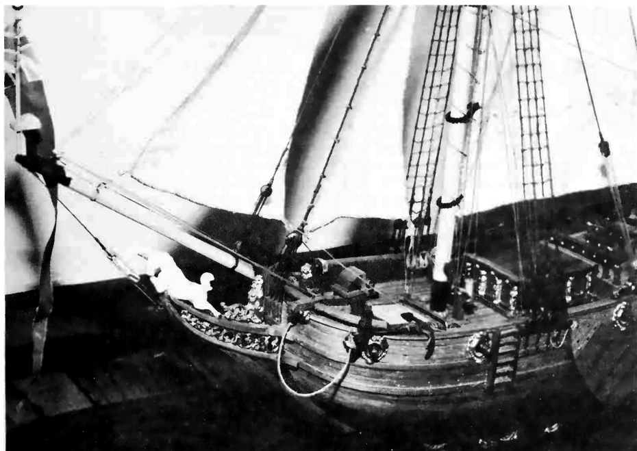
Рис. 4-46. Моя модель яхты Mary, с простой структурой гальюна. Необходимо сделать только чаки гальюна..
