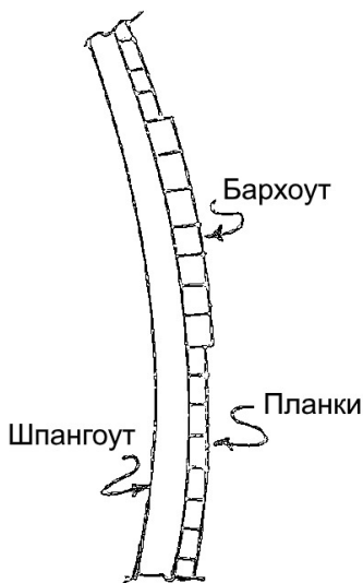
Рис. 3-1. Толщина обшивки корпуса не всегда одинакова. Бархоут гораздо толще, чем остальные планки.
