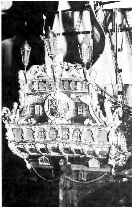
Рис. 4-37. Корма моей модели Friesland в процессе изготовления. Это модельный набор с обшивкой на шпангоутах. Как и многие другие детали корма покрыта золочеными листьями.
