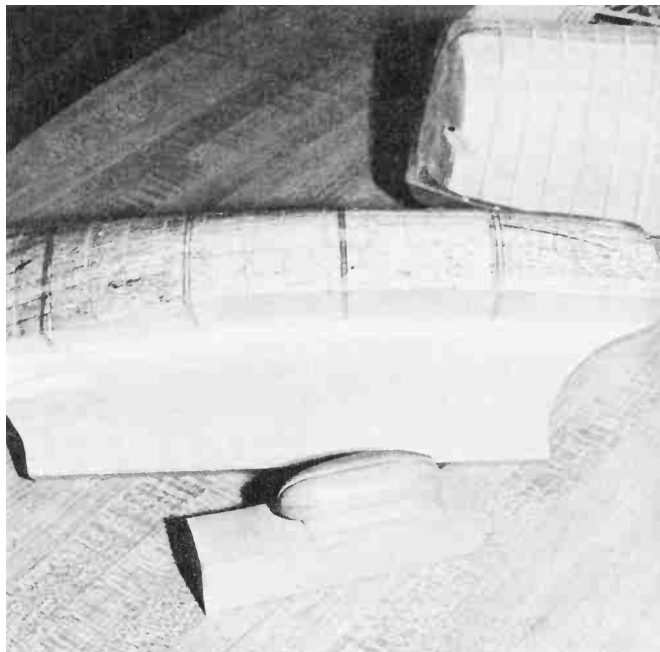
Рис. 5-3. Матрица-шаблон Боба Саддориса для изготовления шляпки. Маленький шаблон для шляпки модели, а большой — для отдельной модели самой шляпки.
