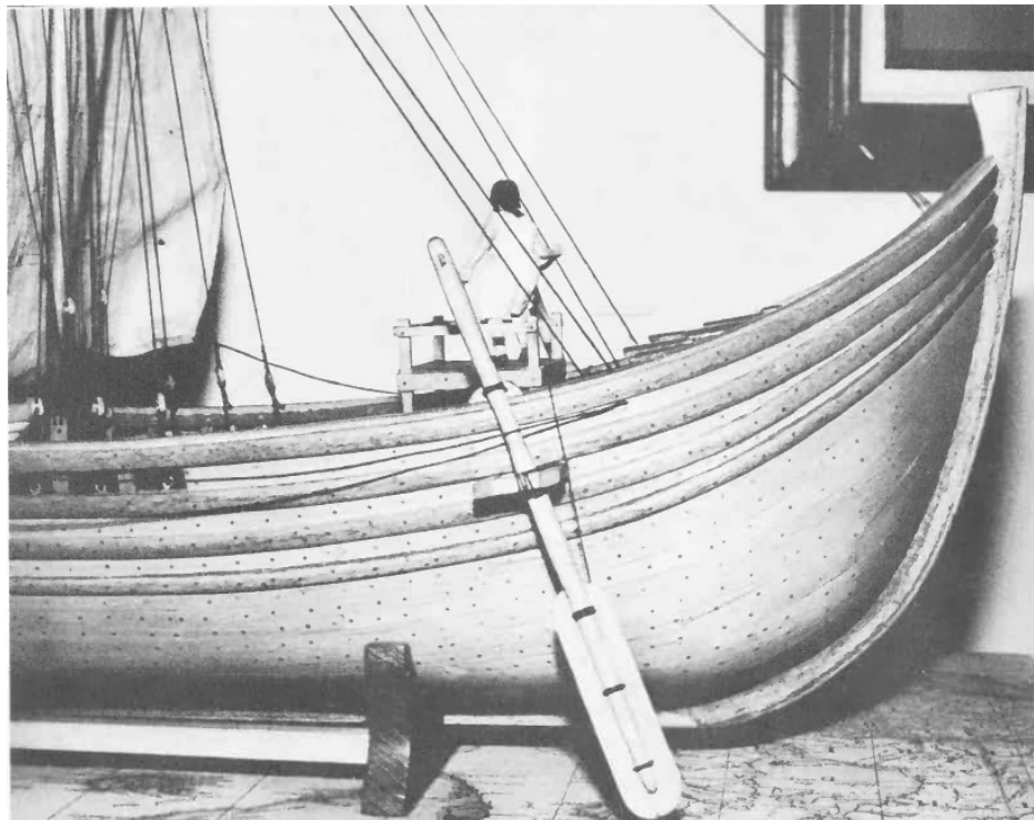
Рис. 3-38. Пример очень трудной обшивки, выполненной Генри Брайденбеккером на своей модели судна с острова Яссыада. Генри использовал приспособления для фиксации планок и на носу, и на корме.
