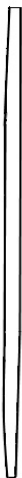
Рис. 3-37. Типичная зауженная планка, готовая к установке на корпус. Если вы показываете стыки (что является самым правильным способом), планка будет конечно короче, но все равно ее придется зауживать.
