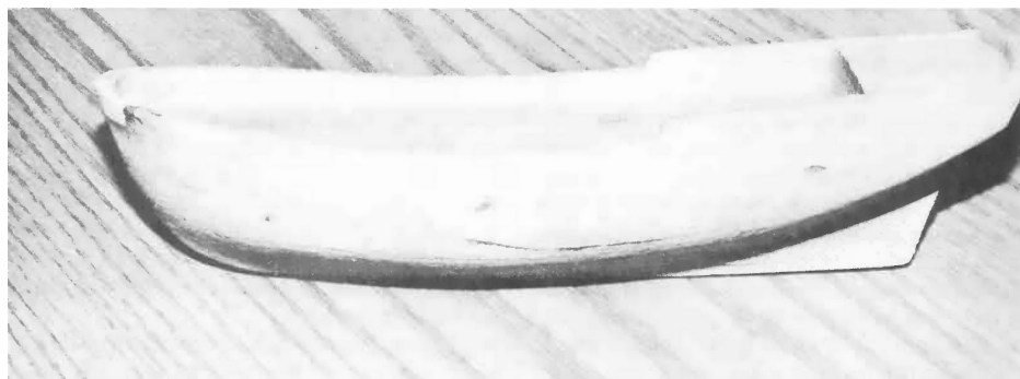
Рис. 1-2. Пример типовой структуры монолитного корпуса из модельного набора Model Shipways.
