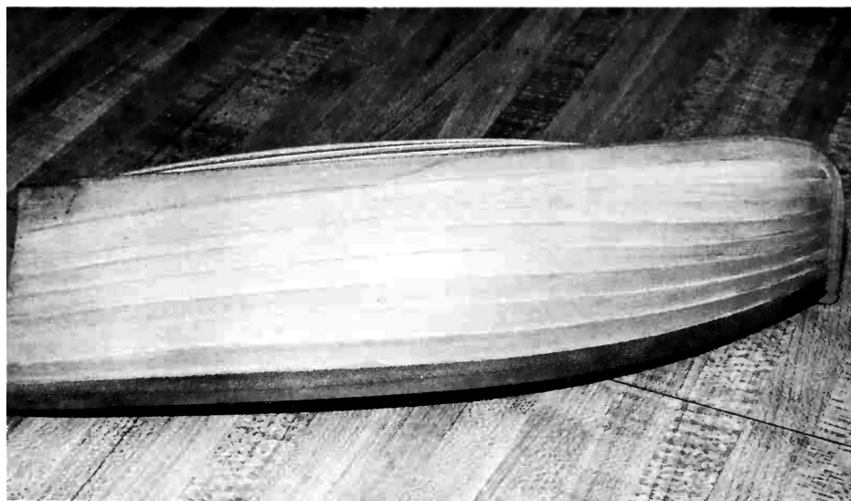
Рис. 5-9. Плоскодонка Боба Саддориса с клинкерной обшивкой. Планки настолько тонки, что через них можно увидеть свет.
