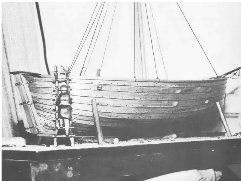
Рис. 3-49. Последняя фотография модели корабля из Кальмара, сделанная Генри Брайденбеккером, демонстрирует бимсы, выходящие из обшивки. Это также пример обшивки внакрой.
