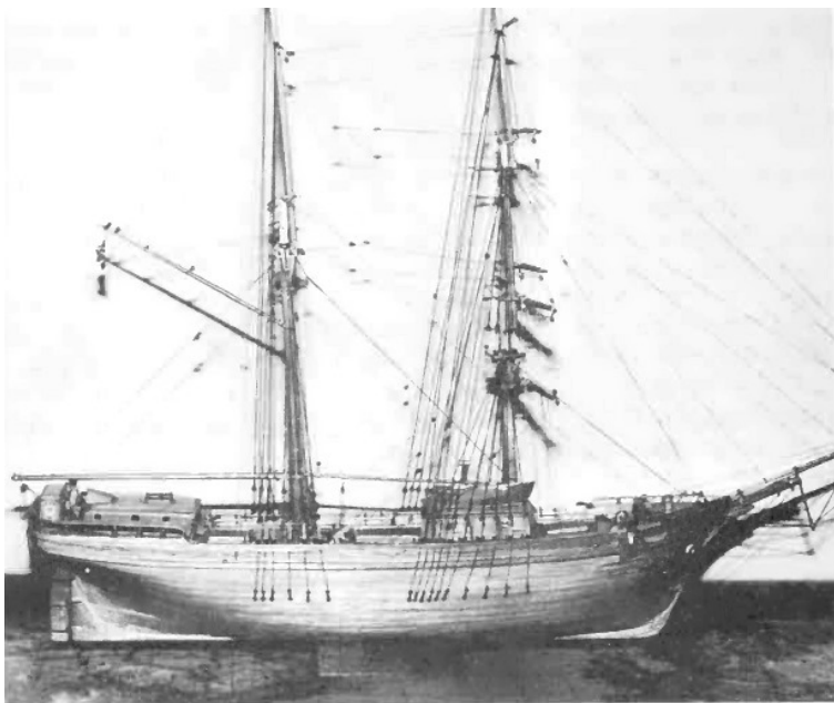
Рис. 3-41. Модель брига Леон Боба Саддориса, построенная по чертежам Гарольда Андерхилла. Обратите внимание, что Боб решил полностью обшить корпус и скрыл всю свою работу по изготовлению шпангоутов.
