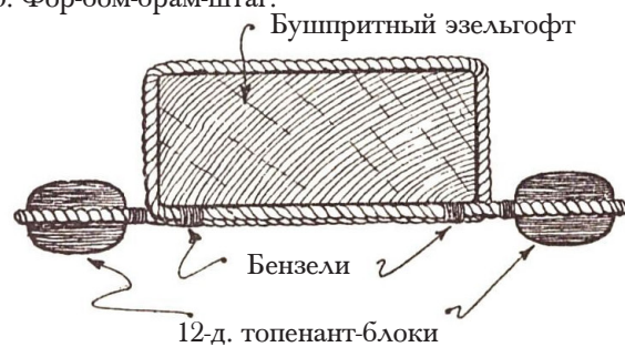
Рис. 168. Установка блоков блинда-топенантов.
