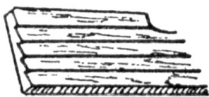
Рис. 6. Имитация обшивки внакрой
