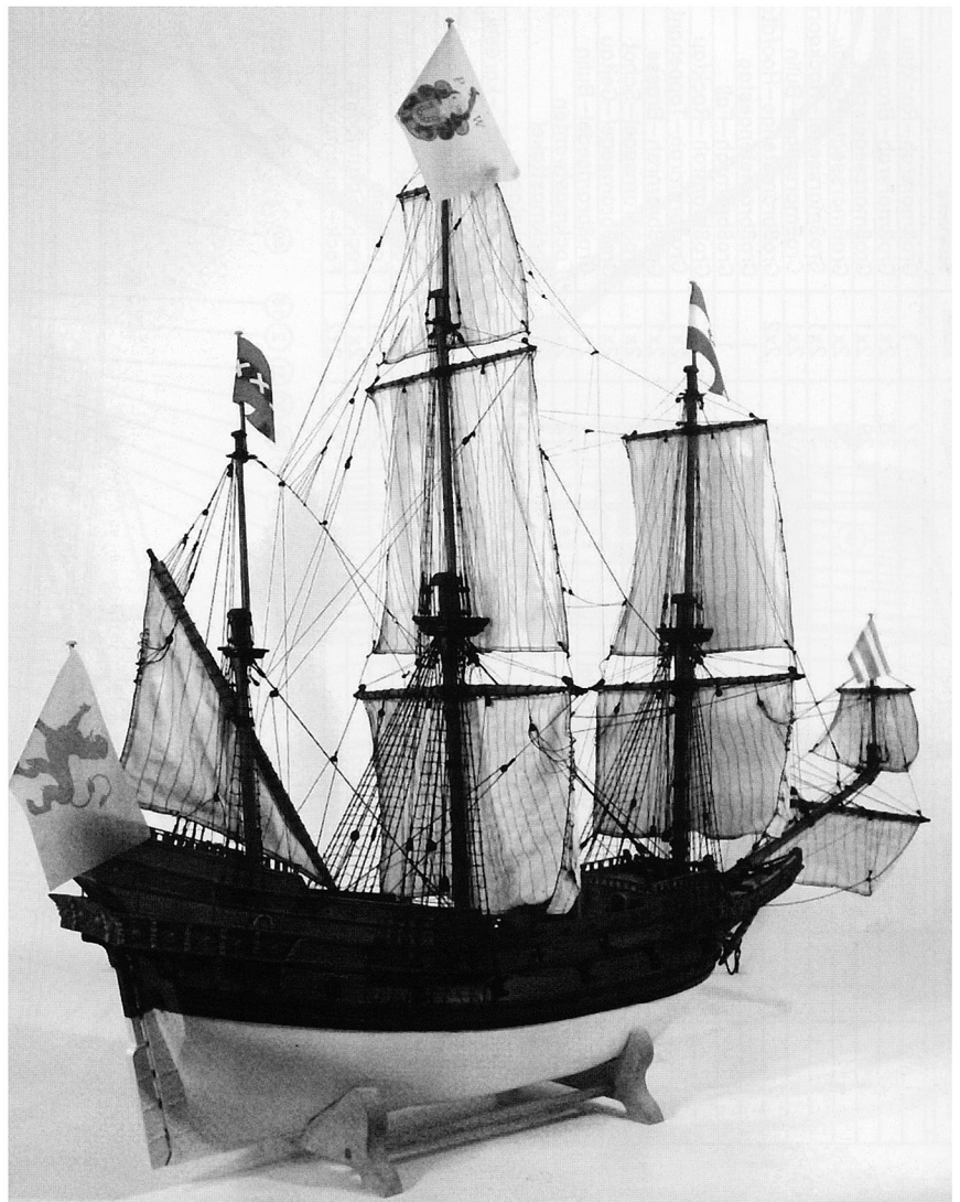
Abb. 17: Das fertige Modell. Die Abmessungen sowie der Stand der Masten wurden dem Gemälde van Verbeecks entnommen.
