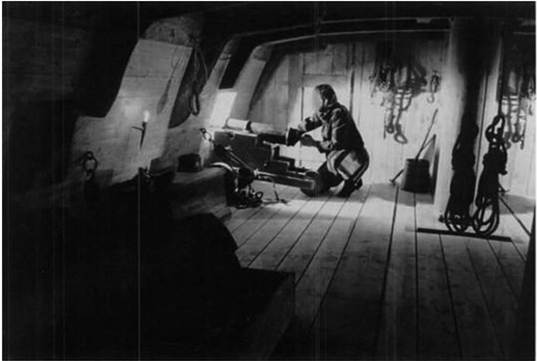
Afbeelding 76: Deel van de overloop ter hoogte van de grote mast, op werkelijke grootte nagebouwd in Musrum 't Behouden Huys op Terschelling. Het driewielig rolpaard is een reconstructie van een in het scheepswrak SO1 gevonden exemplaar. Foto: Gerald de Weerd.
