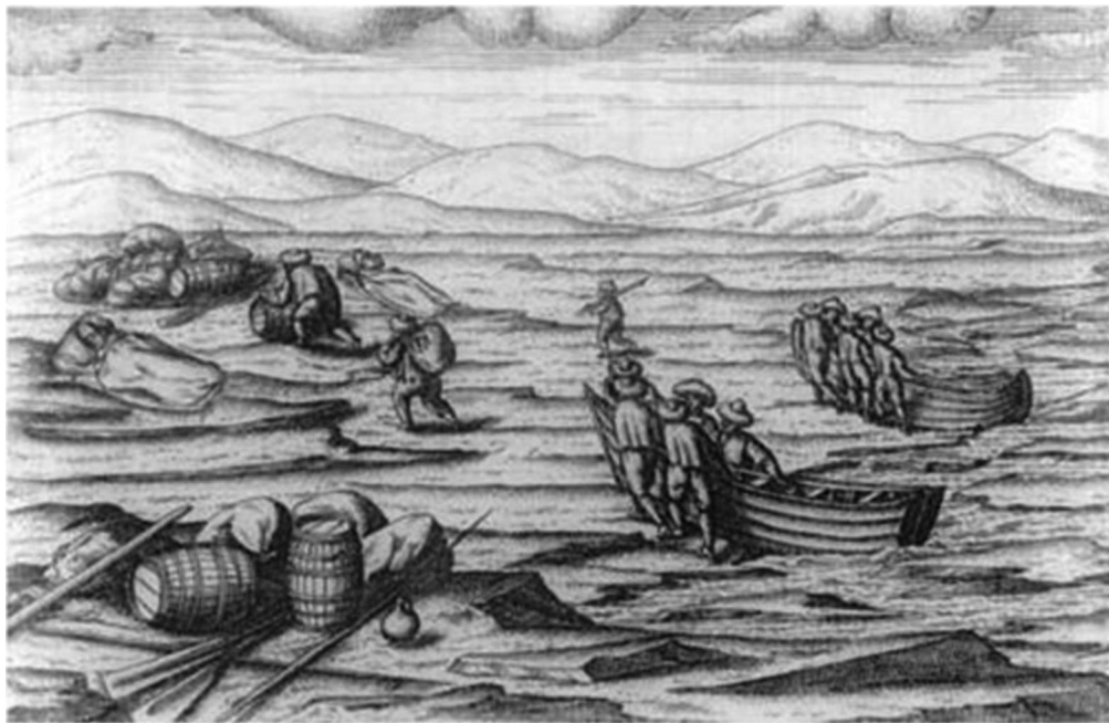
Afbeelding 54: Prent nr. 21 uit De Veers dagboek. Het verschil in constructie van de twee boten is duidelijk weergegeven, het verschil in grootte niet. Op de voorgrond de bok met overnaadse zijbeplanking en achterspiegeltje, daarachter de platboomde schutt met ronde stevens.
