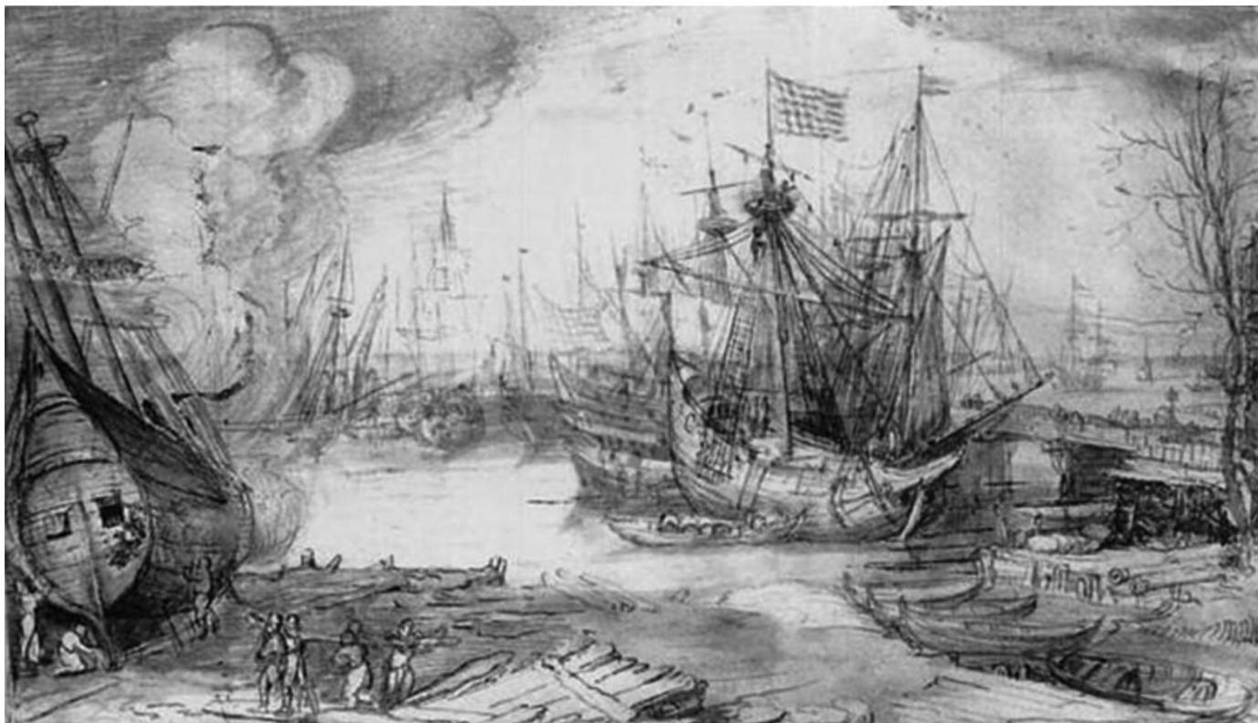
Afbeelding 68: Scheepswerf door C.C. van Wieringen omstreeks het begin van de zeventiende eeuw. Het scheepje links laat de typerende vorm van het achterschip zien. Smith College of Art, Northampton. Massachusetts. USA.
