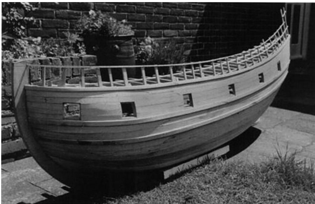
Afbeelding 74: Reconstructie model schaal 1: 10, uitgevoerd als halfmodel. De oplangers (spanten) eindigen aan de bovenzijde tegen het rahout. De opbouwen, de bak en het halfdek, worden er pas later op gebouwd en maken nog geen deel uit van de romp zelf. Foto: Gerald de VVeerd.
