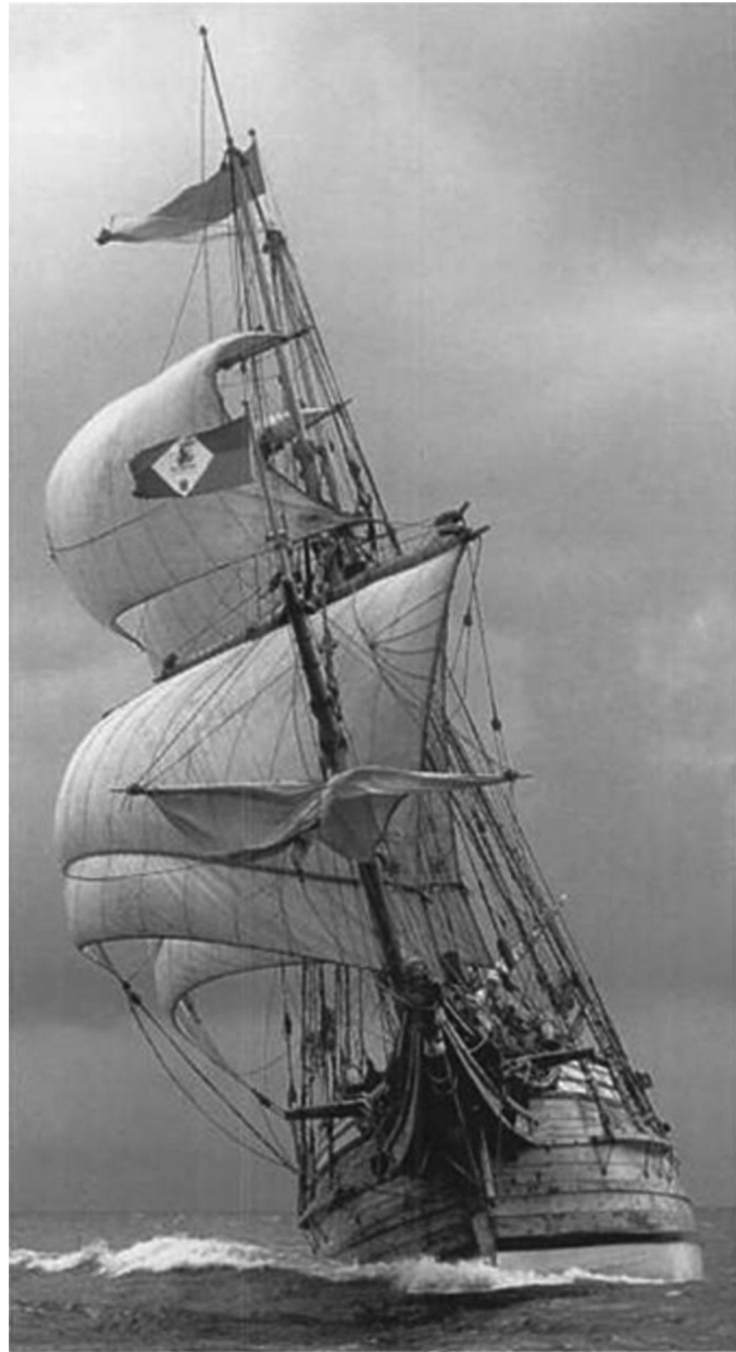
Afbeelding 38: De replica van de 'Duyfken' onder harde wind. De marszeilen zijn halfweg de steng geplaatst, waarmee effectief het windvangend opperlak wordt verkleind. We zien dit beeld regelmatig op schilderijen van rond die tijd. Foto: Robert Garoey.
