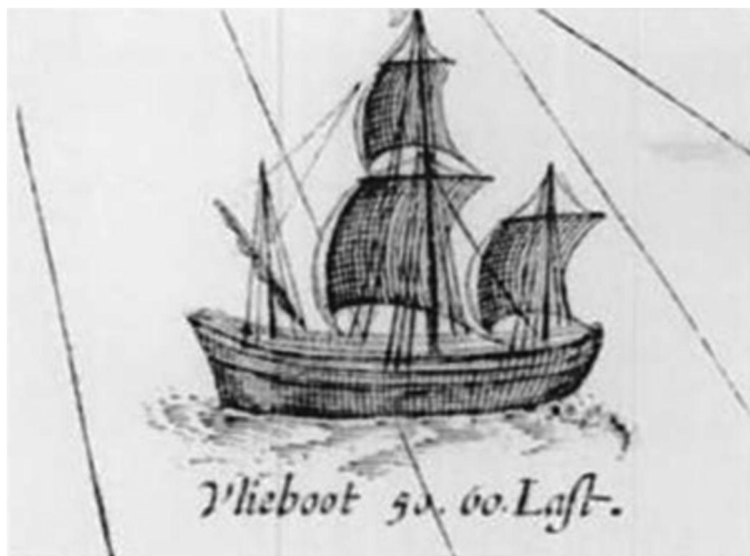
Afbeelding 70: Detail van de kaart van Hondius en Kaerius met afbeelding van een vlieboot. Deze schepen werd meest 'geslegt' dus zonder opbouw uitgevoerd. (Zie ook afbeelding 28 op pag. 46) Copyright Leiden, Leiden University Library, collectie Bodel Nijenhuis.
