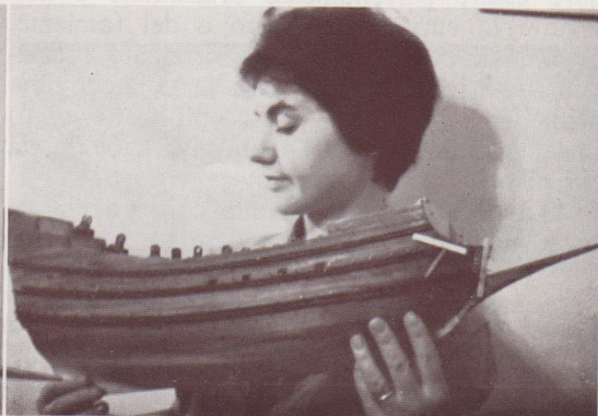
Figg. 61, 62 e 63 - Applicazione degli incintoni superiori e del capo di banda.
