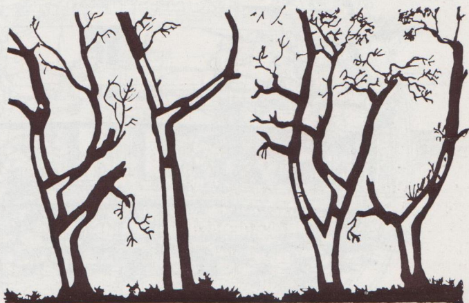
Fig. 5 - Foreste intere si trasformavano in vascelli. I tagliatori squadravano i tronchi d'albero ed - a seconda della forma che veniva data loro - i pezzi venivano destinati all'armatura della nave od al fasciame di rivestimento. I carpentieri poi, con l'ascia, davano la forma a tutti i pezzi, che venivano uniti per mezzo di lunghi chiodi.
