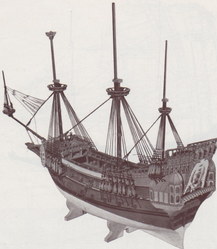
Fig. 158 - Messa in opera delle sartie e degli stragli inferiori. Modello, in costruzione, e foto, di Vincenzo Lusci, Firenze. (Disegno costruttivo Ed. Lusci, Firenze).
