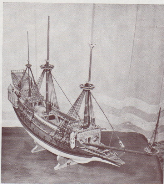
Le sartie negli alberi inferiori de « La Couronne » (Modello e piano costruttivo di Vincenzo Lusci, Firenze).
