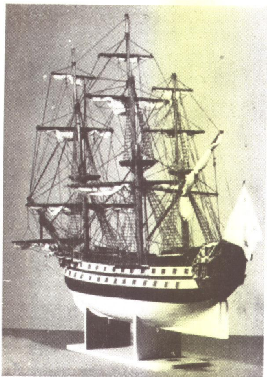
Fig. 285 — Altezza sbagliata dei pennoni in un modello con vele ammainate.
