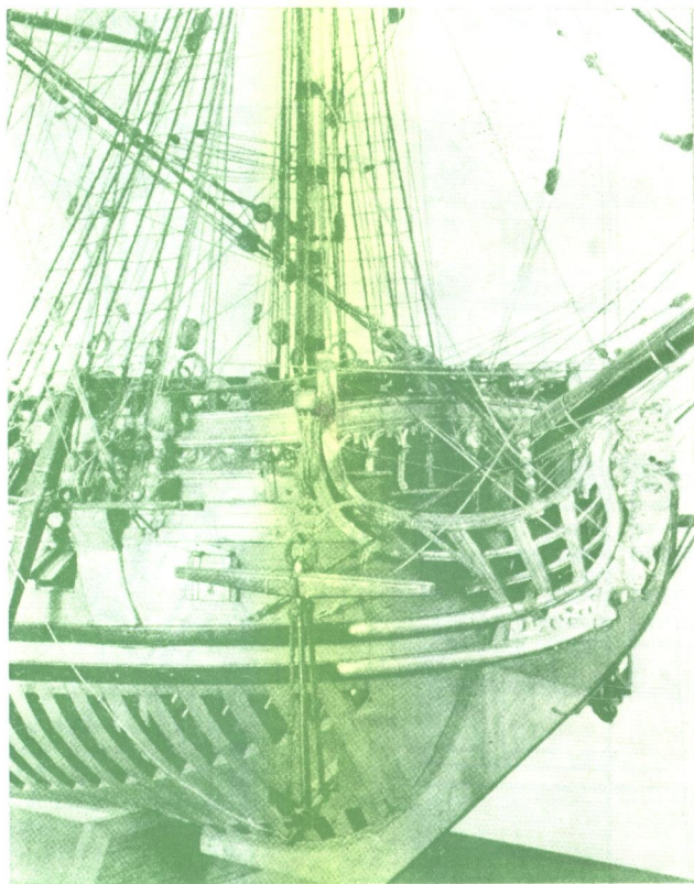
Fig. 195 — Particolare di un modello di fre- gata francese costruito dal Sig. Alberto Fri- gerio, di Firenze - Notare l'accuratezza dei cannoni, e della loro imbracatura.
