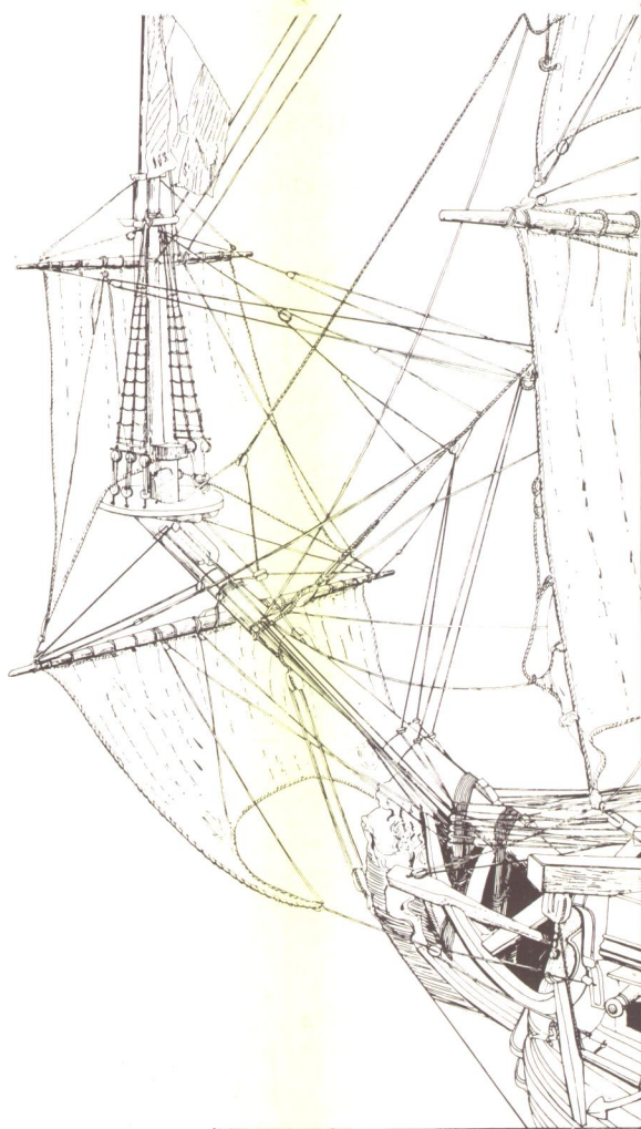
Fig. 257 — Albero di bompresso con civada ed alberetto e vela di controciçada.
