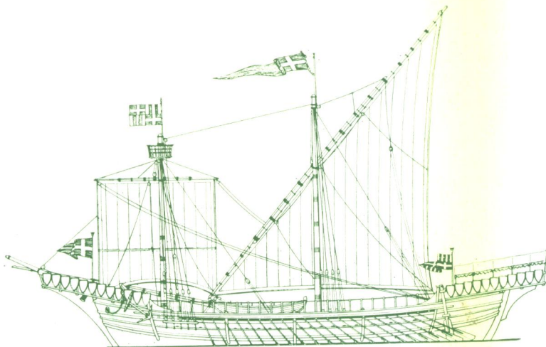
Fig. 315 — Uxer catalano (sec. XVI) - Disegno costruttivo Ed. Lusci.
