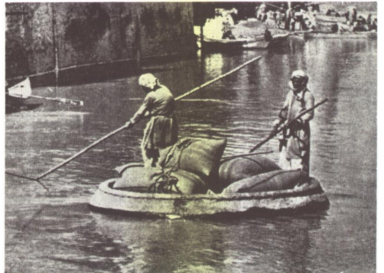
Fig. 291 — Ancora oggi, sull'Eufrate, si incontrano natanti di questo tipo. Sono grosse ceste ricoperte da pelli d'animale, ed a volte trasportano carichi anche notevoli.
