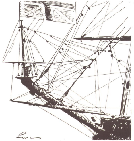
Fig. 255 — Civada e controciavada in una nave del XVII secolo.
