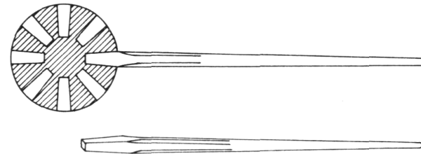
Установка вымбовок в шпиль.
