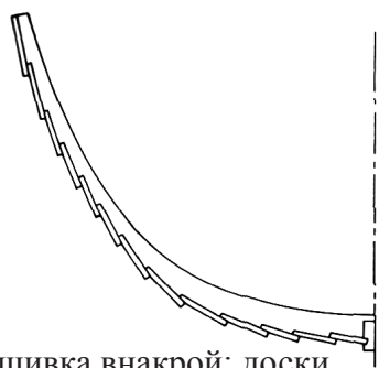
Обшивка внакрой: доски обшивки внахлест. Североевропейская система.
