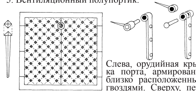
Крышки портов: 1. Снаружи; 2. Изнутри; 3. Внешний вид; 4. Иллюминатор; 5. Вентиляционный полупортик.
