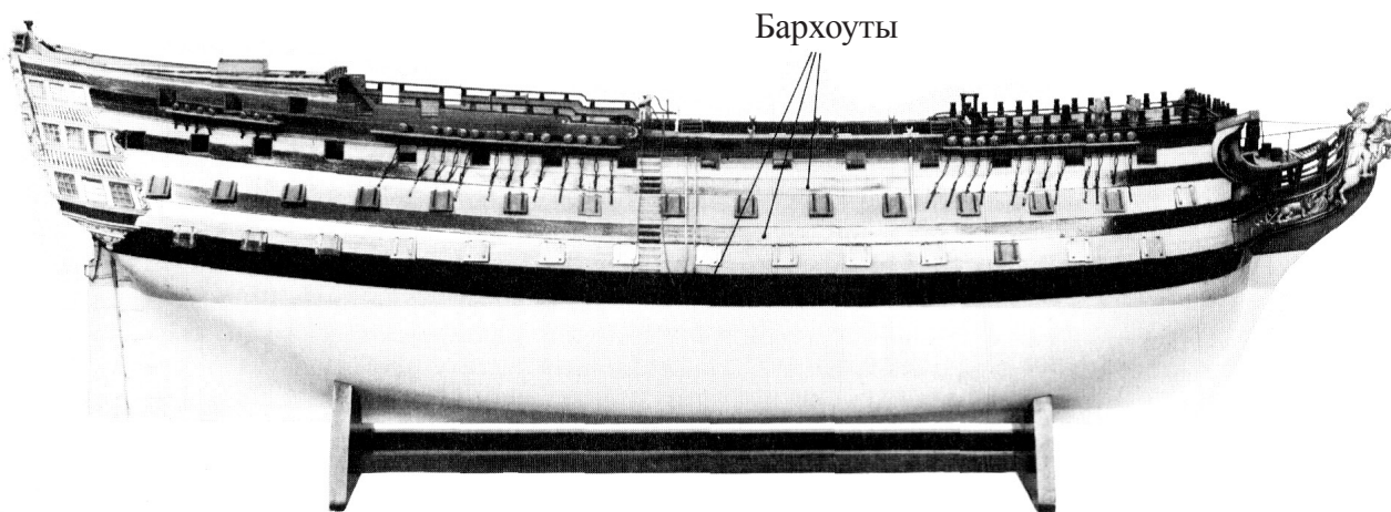
Корпусная модель английского трехпалубного корабля «Воупе» 1790 года
