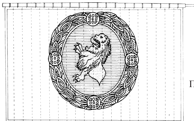
Немецкий грот и грот-марсель с модели Peller 1603 года, один из первых примеров нижней шкаторины с выемкой.
