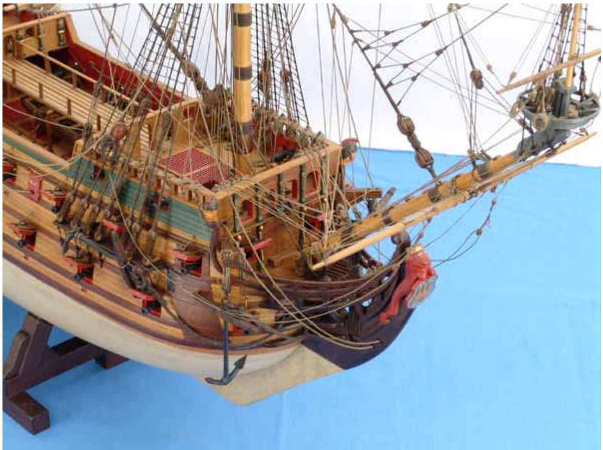
Abb. 23, 24 Vorschiff mit Galion und Backdeckschotten
