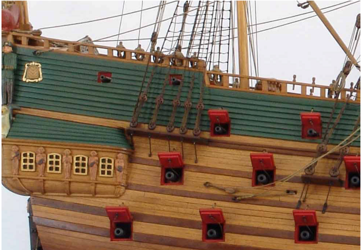
Abb. 29 Achterschiff mit Seitentasche und Besan-Rüste
