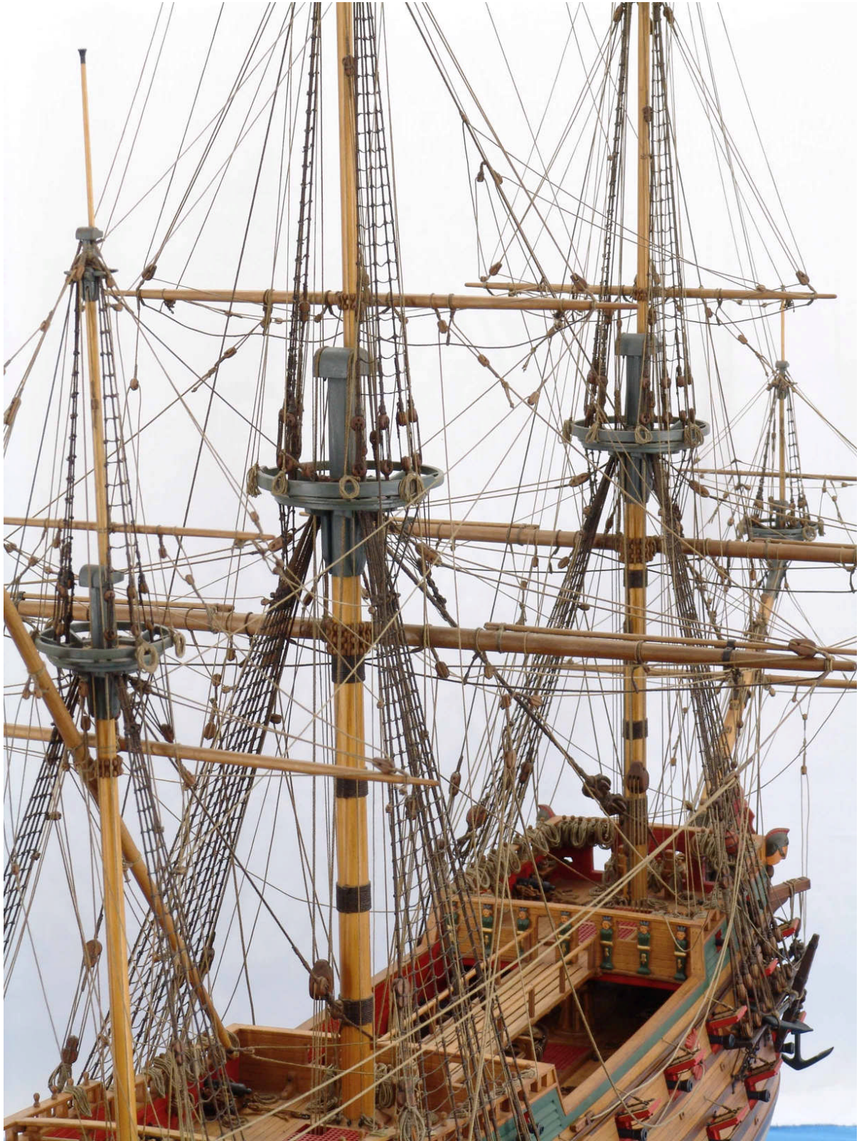
Abb. 34 Mars des Besan-, Groß-, Fockmastes
