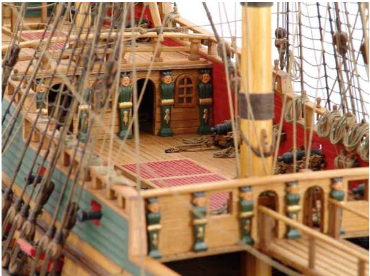
Abb. 26, 25 Endschott des Backdecks
