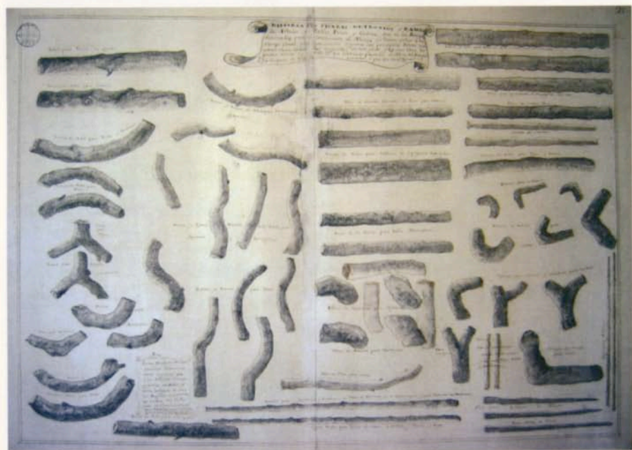
Lámina que representa las formas de los troncos cortados con el fin de que se ajusten lo más posible a la pieza del navío. Álbum del Marqués de la Victoria, AP.
