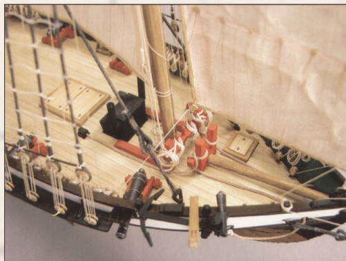
en: Riggin of the foresail, square schooner had from one to three square sails. ru: На шхуне с прямым парусным вооружением было от 1 до 3 прямых парусов.
