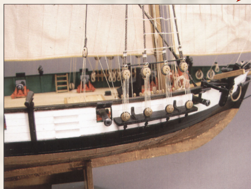
en: Foremast shroud, open gunports, steps on the side ru: Фок-мачта, открытые орудийные порты ступеньки по бокам
