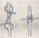
en: Tying shrouds deadeyes. ru: Завязывание вант на юферсах
