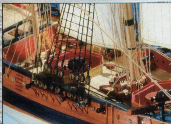
Lawa wantowa grotmasztu. Widoczne kołkownice przymaszto.
