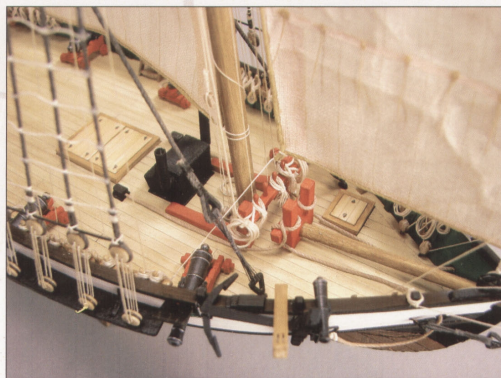
➤ Olinowanie fokmasztu, szkuner rejowy posiadał od jednego do trzech żagli rejowych.
