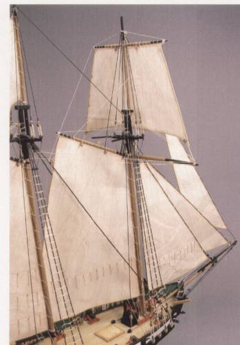
➤ Olinowanie fokmasztu, szkuner rejowy posiadał od jednego do trzech żagli rejowych.
