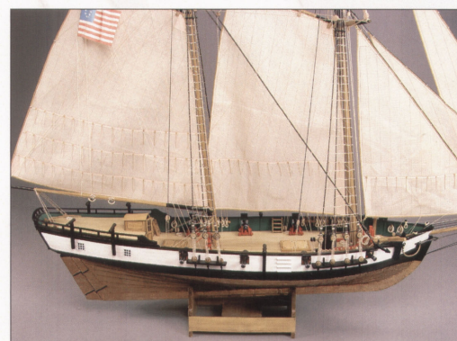
▲ Zejście do kabin na rufie osłonięte było konstrukcją z daszkiem.
